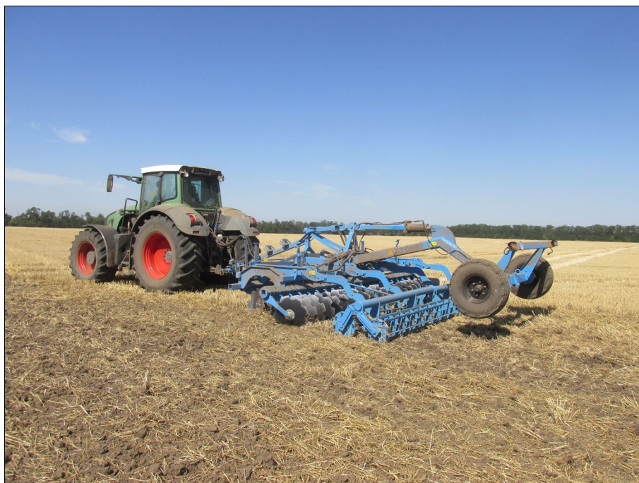
Рисунок 2 – Агрегат дисковый "TIGARBO" АДС-5 в агрегате с трактором FENDT 936 на дисковом лущении стерни озимой пшеницы (1 след)
