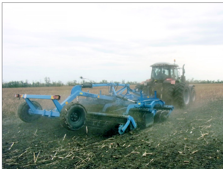
Рисунок 3 – Агрегат дисковый "TIGARBO" АДС-5 в агрегате с трактором UMG T2604 на дисковом лущении пожнивных остатков кукурузы (1 след)
