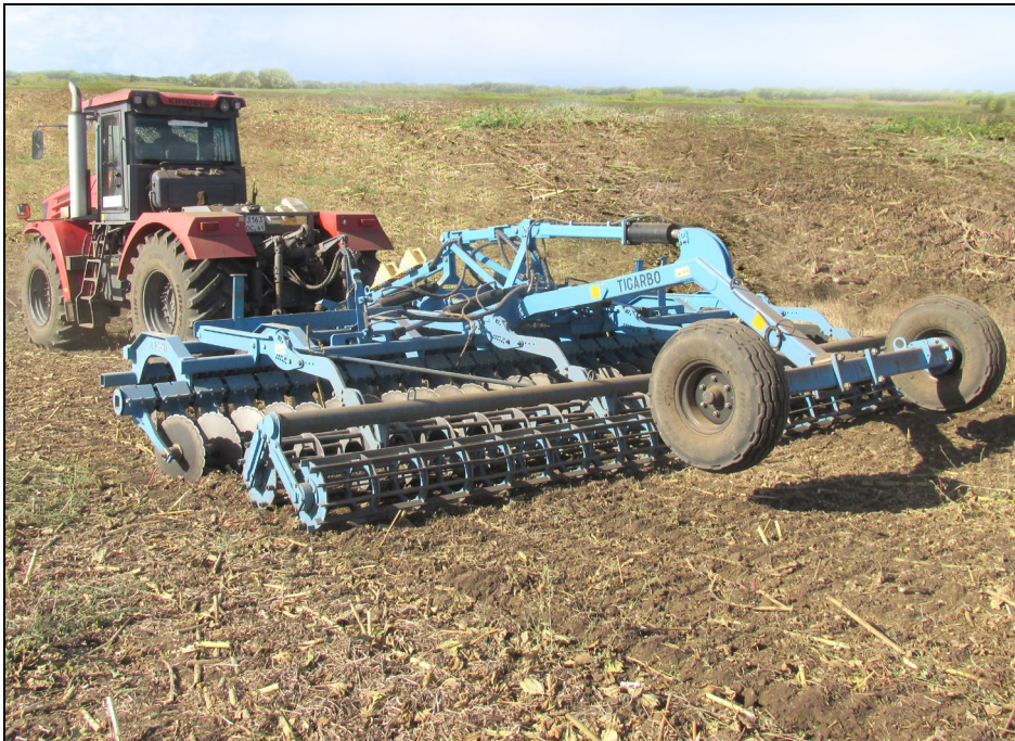
Рисунок 3 – Агрегат дисковый "TIGARBO" АДС-7, в агрегате К744РЗ на дисковом лущении пожнивных остатков подсолнечника (1 след)
