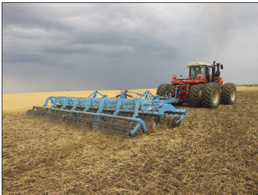
Рисунок 2 – Агрегат дисковый "TIGARBO" АДС-8 в агрегате с трактором RSM 2375 на дисковом лущении стерни озимой пшеницы (1 след)
