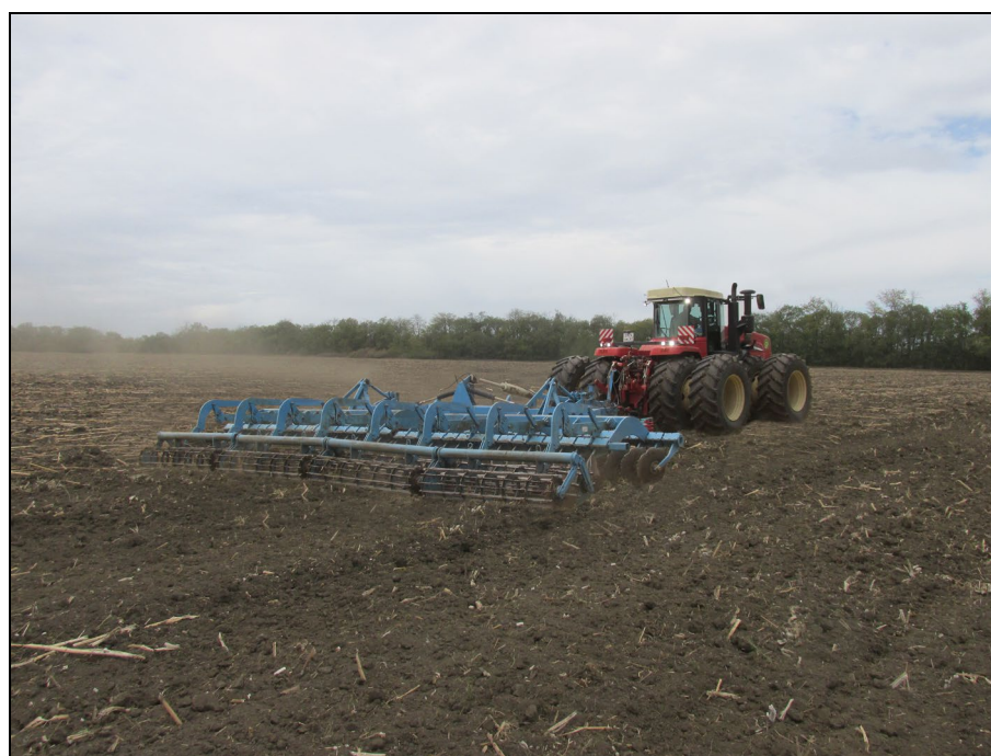
Рисунок 3 – Агрегат дисковый "TIGARBO" АДС-8 в агрегате с трактором RSM 2375 на дисковом лущении пожнивных остатков подсолнечника (2 след)
