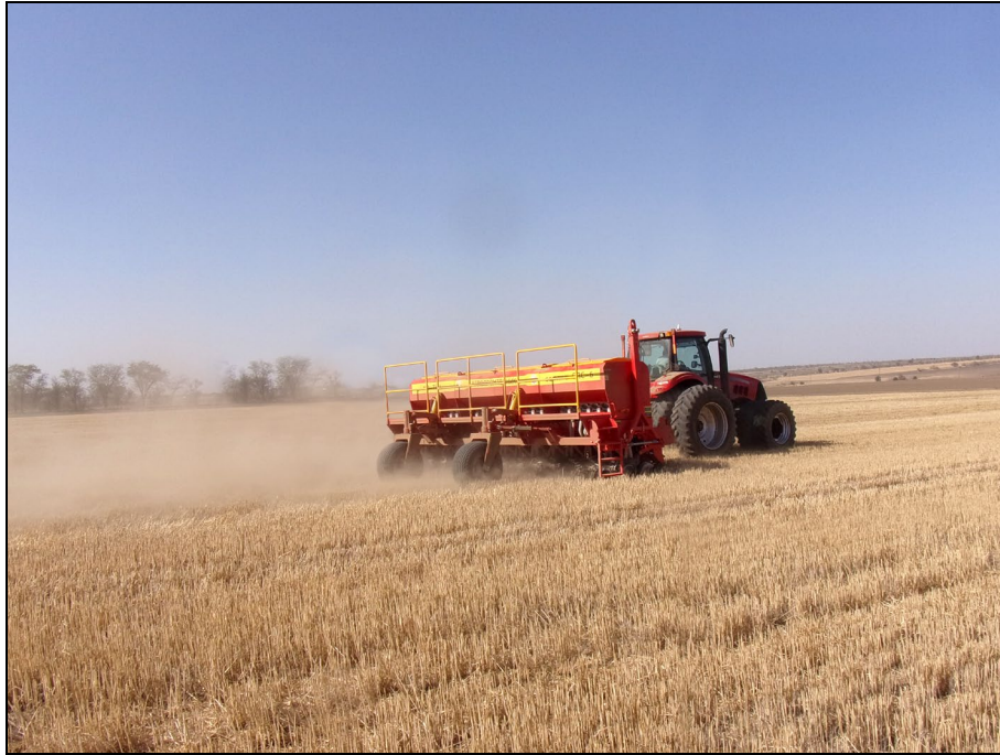
Рисунок 4 – Сеялка СПС-6НК в агрегате с трактором CASE 310, на посеве озимой пшеницы
