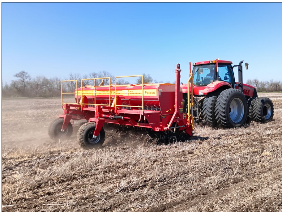
Рисунок 3 – Сеялка СПС-6НК в агрегате с трактором CASE 310, на посеве семян люцерны
