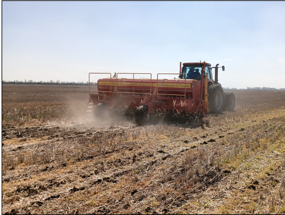
Рисунок 2 – Сеялка СПС-6НК в агрегате с трактором CASE 310, на посеве семян гороха
