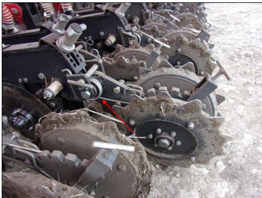
Рисунок А.2 – Излом пружины кручения на прикатывающем колесе высевающей секции сеялки
