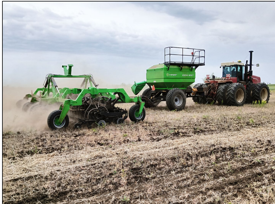
Рисунок 3 – Посевной комплекс Дон 657 (анкерный), в агрегате с трактором RSM 2375, на посеве семян люцерны
