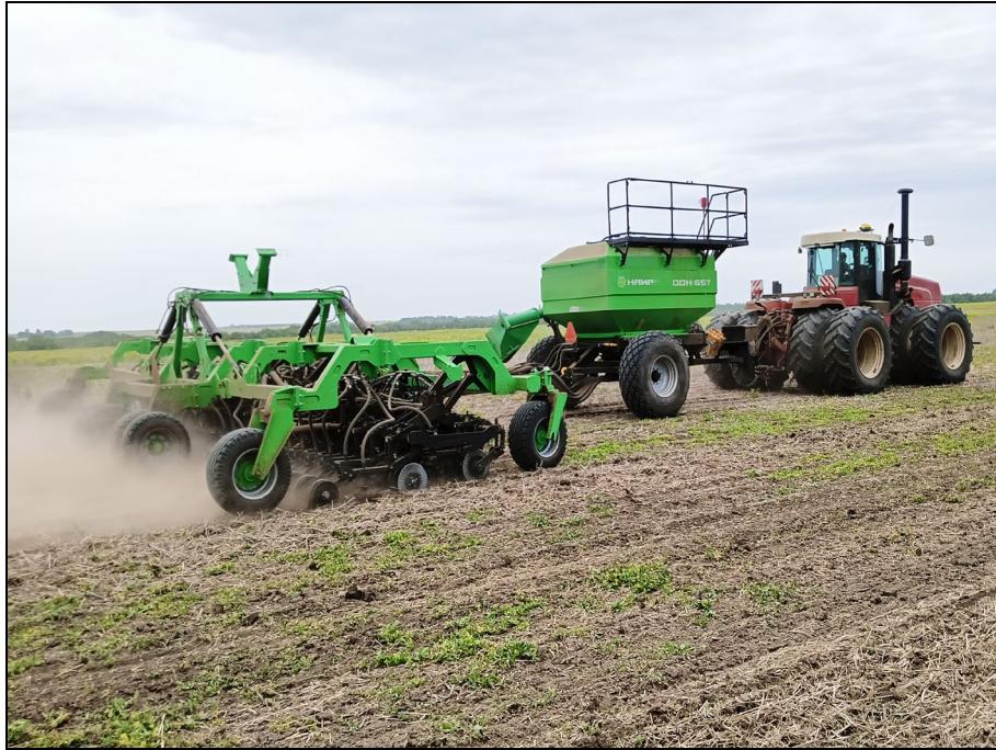
Рисунок 2 – Посевной комплекс Дон 657 (анкерный), в агрегате с трактором RSM 2375, на посеве семян гороха
