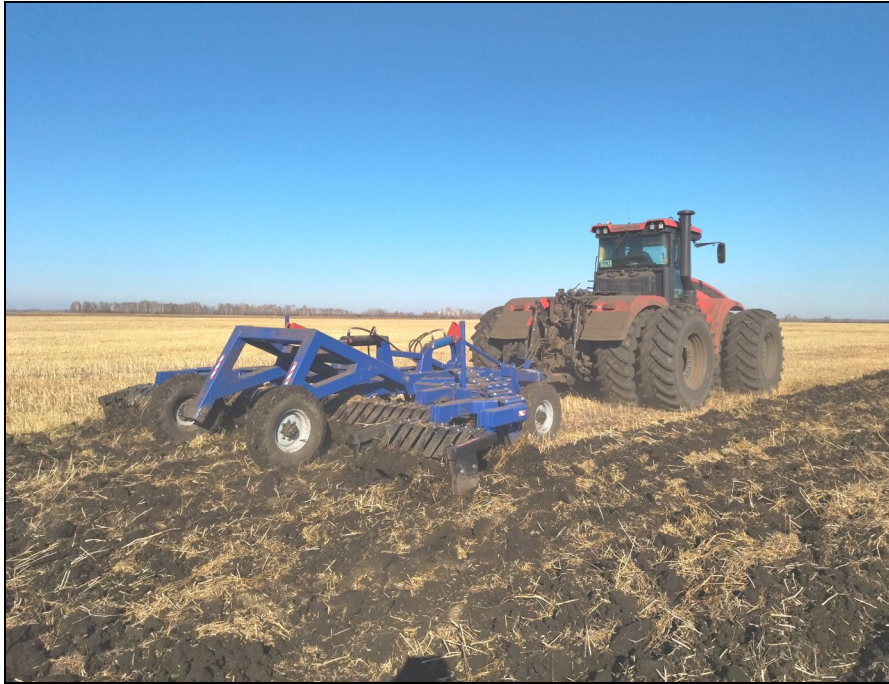
Рисунок 2 – Плуг чизельный прицепной ПЧП-6У в агрегате с трактором "Кировец" К-742МСт1, на безотвальном рыхлении почвы
