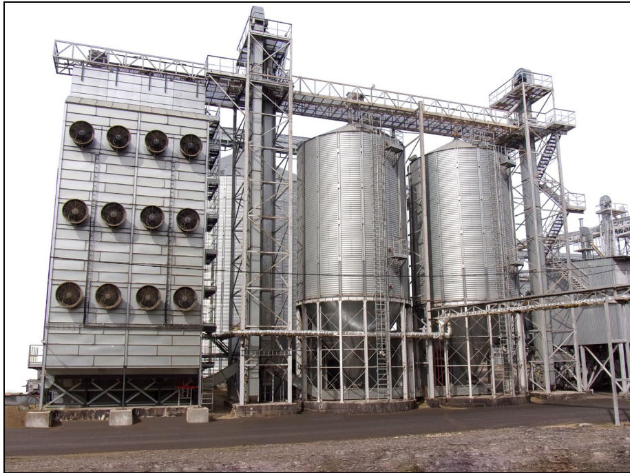
Рисунок 1 – Сушилка шахтная с рекуперацией серии S, модель S16-28, вид спереди
