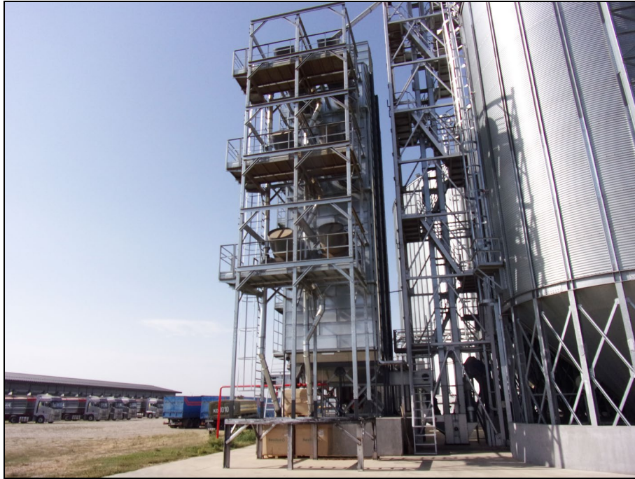
Рисунок 2 – Сушилка шахтная серии SD-L торговой марки КОБЛИК, модель SD-L 8-28 в составе зерноочистительно-сушильного комплекса, в работе
