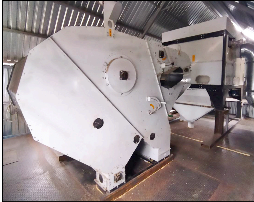
Рисунок 2 – Машина предварительной очистки зерна МПО-50, на предварительной очистке зернового вороха
