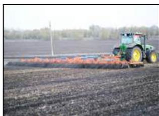
Культиватор КПО-13СМ в агрегате с трактором John Deere 8320R на предпосевной обработке почвы
