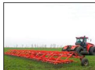
Борона пружинная БП-21 в агрегате с трактором К-742М на бороновании озимых посевов
