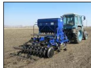
Сеялка-культиватор зернотуковая для полосного посева СКП-2,1Ж.У в агрегате с трактором МТЗ-80 в работе, на стерне
