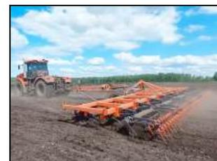
Культиватор сплошной серии КС(М), модели КС-12(М)-03.00 EURO в агрегате с трактором "Кировец" К-739МСт1 на предпосевной культивации почвы
