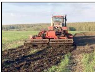
Культиватор секционный диско-лаповый торговой марки "Solar Fields" серии СДК, модель: СДК-4П-01.00 EURO в агрегате с трактором "КИРОВЕЦ" К-735М на сплошной обработке почвы
