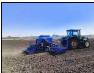
Сеялка С-7,2ПМ2 в агрегате с трактором John Deere 7820, на посеве гороха
