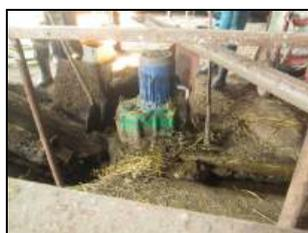
Привод горизонтального транспортера КСН-Ф-100
