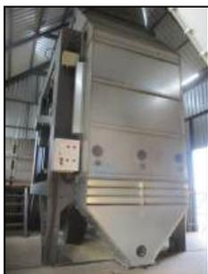
Сепаратор высокопроизводительный универсальный серии "UNIVERSAL", модель U-120 в технологической линии зерноочистительно-сушильного комплекса на предварительной очистке вороха пшеницы
