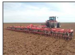
Культиватор сплошной КС-16(УС)-03.00 EURO в агрегате с трактором Case IH Steiger 500 на предпосевной культивации почвы
