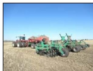
Посевной комплекс "Кузбасс Д" ПК-11,4 в агрегате с трактором RSM-2375 на посеве пшеницы, на стерне
