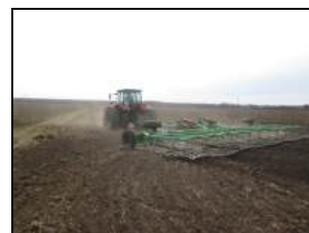
Сцепка зубовая гидрофицированная КАМА LEOPARD-12 на предпосевной обработке почвы
