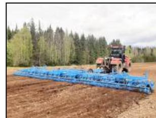
Культиватор полуприцепной КБМ-11-ЗП-Г1К-НС в агрегате с трактором Кировец К735 на сплошной культивации почвы
