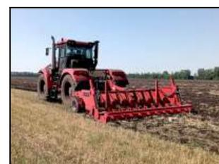
Глубокорыхлитель КАМА TIGER 4 в работе в агрегате с трактором К-742Ст1 на глубоком рыхлении почвы без оборота пласта
