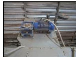
Питающее устройство сепаратора предварительной очистки зерна серии "AIR" модель A-125
