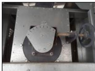
Механизм поворота лотка цилиндра блока сепаратора триерного серии "TRIER" модели T12
