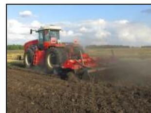
Плуг чизельный торговой марки "Solar Fields" серии ПЧ(У), модели ПЧ-4(У)Н-03.00 EURO в агрегате с трактором RSM 2375, на безотвальном рыхлении почвы
