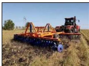
Борона дисковая БДТ-7ПР в агрегате с трактором К-742М Ст1 на основной обработке почвы
