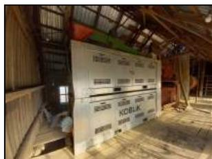
Сепаратор триерный серии "TRIER" модели T12 в работе в составе технологической линии
