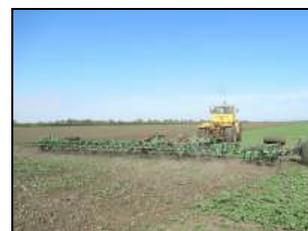
Борона стерневая тяжелая КАМА LION – 15, в агрегате с трактором К-701 на бороновании почвы
