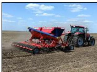
Механический посевной комплекс "Agrator-4800M" в агрегате с трактором "КАМАЗ" ХТХ 215 на посеве яровой пшеницы
