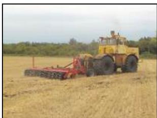
Плуг чизельный навесной ПЧН-4,0КТ в агрегате с трактором К-701 на глубоком рыхлении почвы
