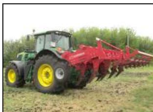
Глубокорыхлитель КАМА TIGER 3 в агрегате с трактором John Deere 6195M в транспортном положении
