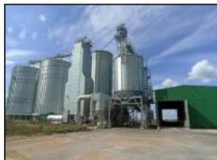
Сушилка зерновая шахтная модульного типа "С" С-80 "Стандарт" (косвенный нагрев, газ) в составе комплекса зерноочистительно-сушильного, производства АО "Агропромтехника"
