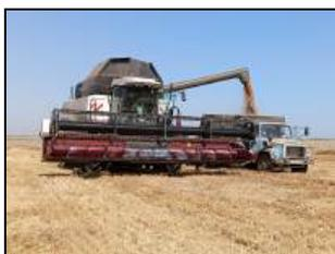
Комбайн зерноуборочный самоходный РСМ-142 "ACROS-585" с жаткой РСМ-081.27 шириной захвата 7 м на выгрузке зерна
