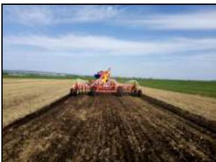
Комбинированный посевной комплекс "Agrator-combi 7200" в агрегате с трактором КаМАЗ ХТХ-215 на посеве по стерне на полях после уборки зерновых с предварительной предпосевной культивацией и интенсивным прикатыванием лент посева
