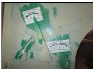
Рычаги с секторами регулировок дробилки
