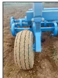
Механизм регулировки глубины обработки
