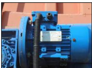
Электродвигатель привода конвейера скребкового
