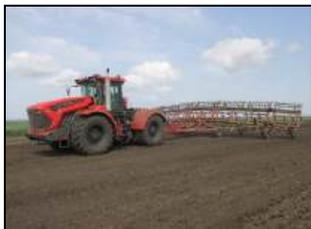
Культиватор сплошной, серии КС(У), модель КС-14(УС)-03.00 EURO, в агрегате с трактором К-742 МСт1 в транспортном положении
