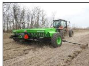
Сеялка Дон 125 в агрегате с трактором TERRION ATM 3180M на посеве по стерне
