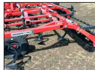
Рабочие органы – стрельчатые лапы на С-образных стойках, каток, пружинная боронка
