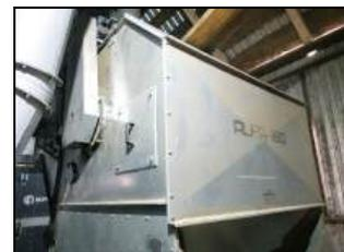
Накопительный бункер оборудования для очистки и сортировки зерна ALFA 150
