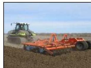
Борона дисковая модульная БДМ-8×4-09 в агрегате с трактором Claas Challenger CH95E на лущении пожнивных остатков подсолнечника
