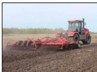
Борона дисковая модульная прицепная БДМП-8×4С в агрегате с трактором К-744Р4 на дисковом лущении пожнивных остатков подсолнечника
