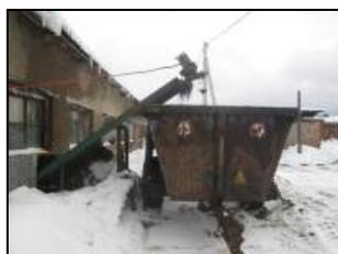
Выгрузная часть наклонного транспортера КСН-Ф-100
