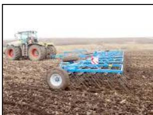
Борона пружинная широкозахватная БПШ-25-01 в агрегате с трактором CLAAS XERION 5000 на бороновании почвы
