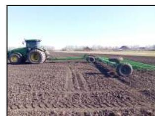
Сцепка зубовая гидрофицированная КАМА LEOPARD-18 в агрегате с трактором Джон Дир 7830 на подготовке почвы к посеву
