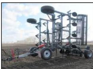
Культиватор для сплошной обработки КСО-7,4 в транспортном положении
