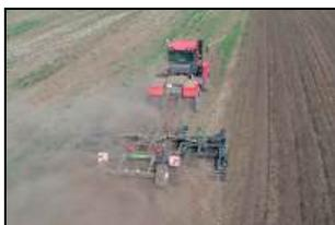
Культиватор для сплошной обработки КСО-7,4 в агрегате с трактором К-730 СтЗ на предпосевной обработке почвы
