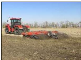
Дисковая борона, торговой марки "Solar Fields", модели БД-7×3ПК-03.00 EURO в агрегате с трактором К-742 М "Кировец" на дисковом лушении стерни озимой пшеницы (2 след)
