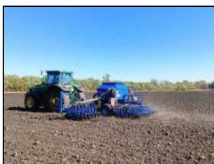
Сеялка С-7,2ПМ2 в агрегате с трактором John Deere 7820, на посеве озимого ячменя
