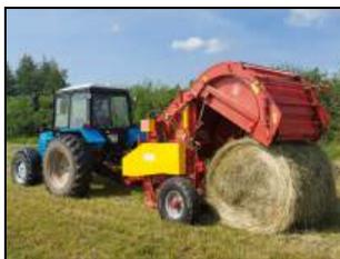
Пресс-подборщик рулонный ПР-140Ц в агрегате с трактором МТЗ-920 на выгрузке рулона из камеры прессования
