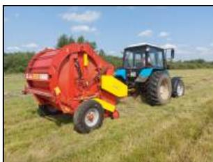
Пресс-подборщик рулонный ПР-140Ц в агрегате с трактором МТЗ-920 на подборе и прессовании сена
