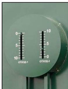
Вид на регулировочные узлы аспирации пневмосепаратора с поворотными барьерами ПСПБ-10
