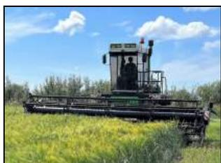
Жатка зерновая валковая SH-309 в агрегате с косилкой "Мещера Е-403" на скашивании и укладке в валки ярового ячменя
