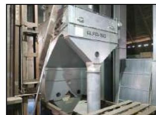
Оборудование для очистки и сортировки зерна ALFA 150
