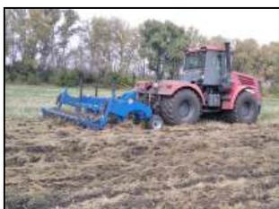
Щелерез-глубокорыхлитель навесной ЩГН-4 в агрегате с трактором "КИРОВЕЦ" К-744Р на сплошной обработке почвы
