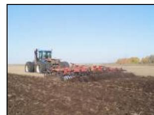
Борона тяжелая дисковая "TORNADO-7000" в агрегате с трактором New Holland 9040 на лущении стерни зерновых культур
