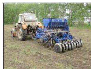
Сеялка-культиватор зернотуковая для полосного посева СКП-2,1А.У в агрегате с трактором МТЗ-80 на посеве пшеницы
