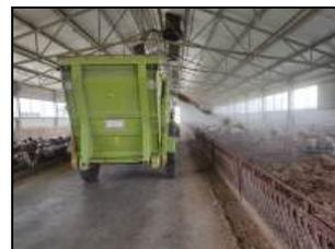
Раздатчик-выдуватель соломы РВС-2500Д "Хозяин" на подаче измельченной массы на подстил при беспривязном содержании коров
