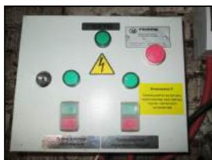
Ящик управления с пусковой аппаратурой транспортера КСН-Ф-100
