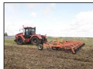
Культиватор предпосевной стерневой КПС-9 в агрегате с трактором К-742МСт1 на предпосевной обработке почвы
