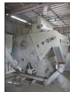
Сепаратор предварительной очистки зерна серии "AIR" модель A-125 в составе поточной линии на предварительной очистке зернового вороха
