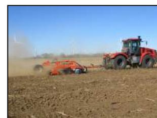
Мульчировщик дисковый полуприцепной ДМ-7×2М в агрегате с трактором "Кировец" К-7 на основной обработке почвы
