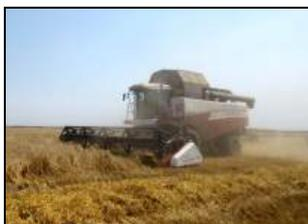
Комбайн зерноуборочный самоходный РСМ-142 "ACROS-585" с жаткой РСМ-081.27 шириной захвата 7 м на прямом комбайнировании озимой пшеницы
