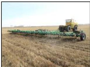
Борона стерневая тяжелая КАМА LION-18, в агрегате с трактором К-701 на бороновании почвы
