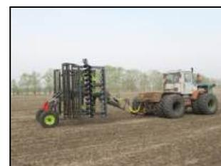
Борона дисковая прицепная VELES БДП-5,2.М в агрегате с трактором Т-150К в транспортном положении
