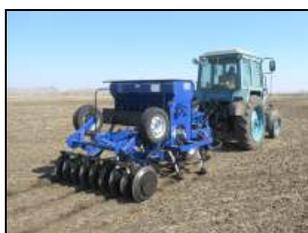
Сеялка-культиватор зернотуковая для полосного посева СКП-2,1В.У в агрегате с трактором МТЗ-80 на посевах пшеницы
