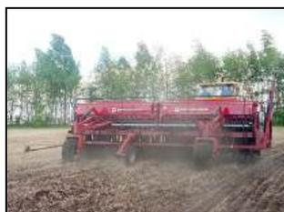
Сеялка прямого сева СПС-6500 в агрегате с трактором К-701 на посеве сои по нулевой обработке (стерневой фон) почвы
