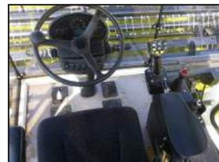
Рабочее место оператора самоходной косилки-плющилки "Мещера Е-403"
