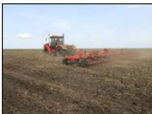
Культиватор сплошной, серии КС(У), модель КС-14(УС)-03.00 EURO, в агрегате с трактором К-742 МСт1 "Кировец", на предпосевной культивации почвы
