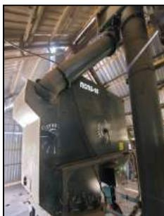
Пневмосепаратор с поворотными барьерами ПСПБ-10 в составе зерноочистительного агрегата ЗАВ-10
