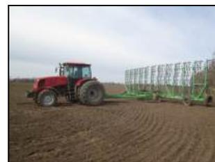
Сцепка зубовая гидрофицированная КАМА LEOPARD-12 в агрегате с трактором МТЗ 2023.3 при переводе в рабочее положение (разворот)
