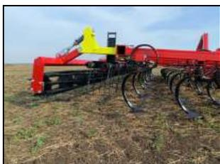
Рабочие органы – стрельчатые лапы на S-образных пружинных стойках, 2-х рядные пружинные боронки, катки
