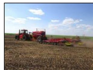
Комбинированный посевной комплекс "Agrator KZS-8500", в агрегате с трактором Т-360 Агромастер на посеве семян пшеницы
