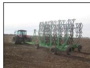
Сцепка зубовая гидрофицированная КАМА LEOPARD-12 в агрегате с трактором МТЗ 2023.3 в транспортном положении
