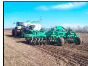
Посевной комплекс "Кузбасс-Д" ПК-7,6 в агрегате с трактором CLAAS AXION 850 на посеве озимой пшеницы
