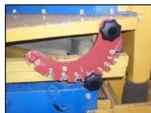
Механизм регулировки угла наклона деки стола вибропневмосортировального ВПС, тип ВПС-5,0
