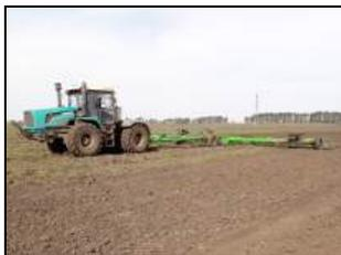
Сцепка зубовая гидрофицированная КАМА LEOPARD-16 в агрегате с трактором БТЗ-243К на подготовке почвы к посеву
