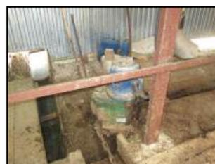
Приводная станция горизонтального транспортера ТСН-160
