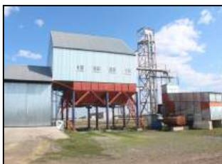
Зерносушилка конвейерная, торговой марки "АТМ", модели АТМ UNIVERSAL-15 в составе зерноочистительного агрегата с ЗАВ-10М
