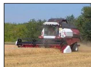
Комбайн зерноуборочный самоходный РСМ-101 "Вектор-410" с жаткой РСМ-081.27 на прямом комбайнировании яровой пшеницы
