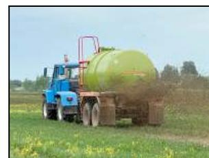
Разбрасыватель жидких органических удобрений РЖОУ-14 "Хозяин" в агрегате с трактором Т-150К на внесении жидких органических удобрений на сельскохозяйственные угодья
