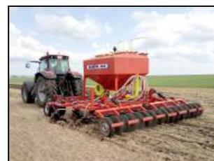
Пневматический посевной комплекс "Agrator-4800" в агрегате с трактором КамАЗ ХТХ-215 на полосном прямом посевах семян с одновременным внесением гранулированных минеральных удобрений по стерновому фону
