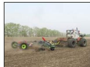
Борона дисковая прицепная VELES БДП-5,2.М в агрегате с трактором Т-150К на предпосевной обработке почвы
