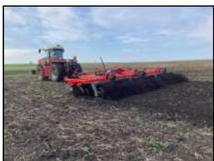
Борона дисковая торговой марки "Solar Fields", модель ЛД-8ПК-03.00 EURO в агрегате с трактором RSM 2375 на предпосевной обработке почвы
