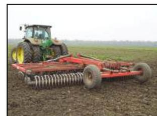
Дисковая борона, торговой марки "Solar Fields", модель БД-6х4ПК-03.00 с трактором John Deere 8310R на дисковом лущении стерни озимой пшеницы
