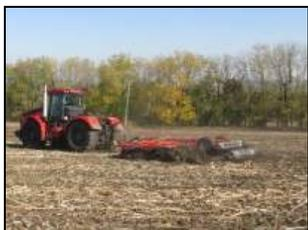
Дисковая борона, торговой марки "Solar Fields", модели БД-7×3ПК-03.00 EURO в агрегате с трактором К-742 М "Кировец" на дисковом лушении пожнивных остатков подсолнечника (1 след)
