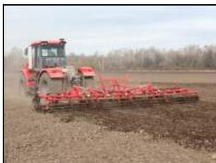
Культиватор широкозахватный универсальный Полярис-8,5 в агрегате с трактором К-744Р4 на культивации паров
