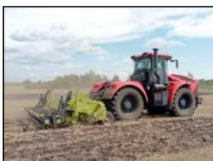
Глубокорыхлитель навесной ГРН-9 в агрегате с трактором К-742МСт на глубокой обработке почвы стернового фона
