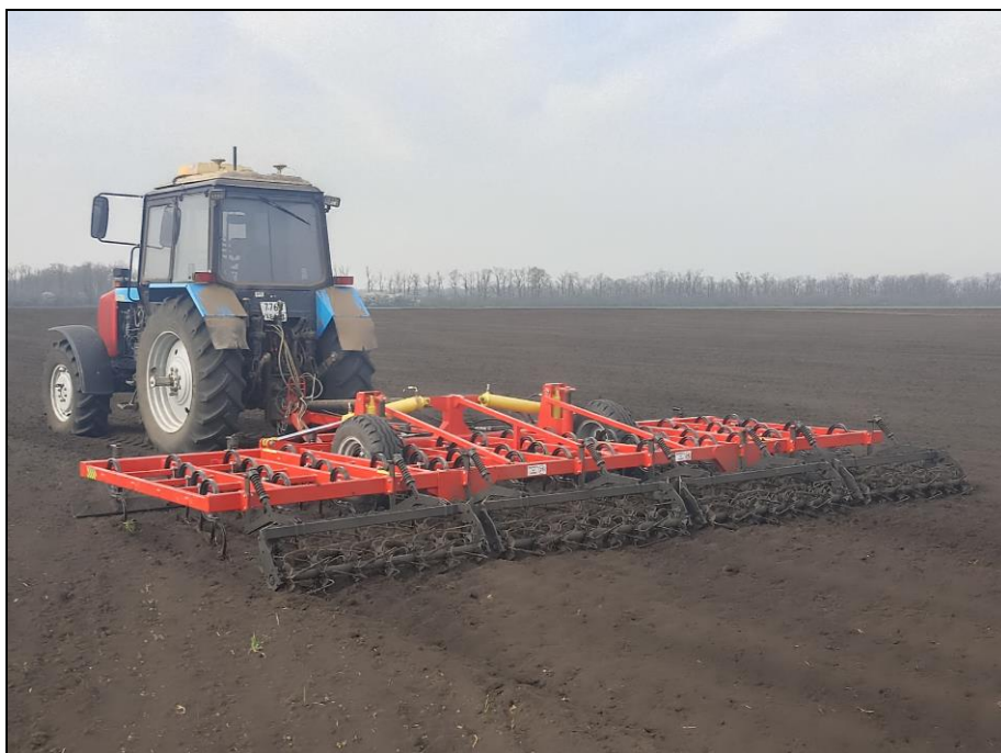
Рисунок 2 – Культиватор КСО-6МТ в агрегате с трактором Беларус-1221.2, на предпосевной культивации
