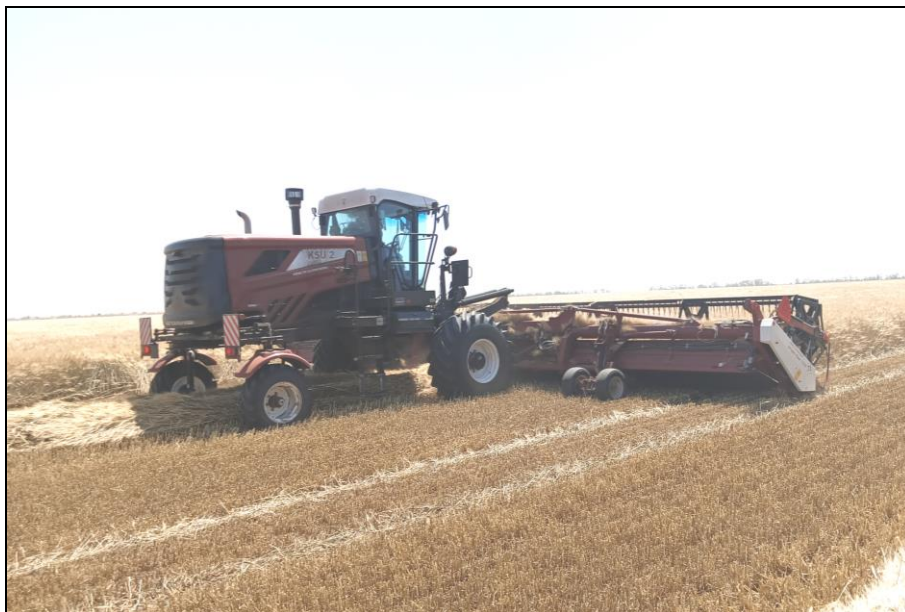
Рисунок 2 – Косилка валковая транспортерная КВТ-2 "Draper Flow 1250" в агрегате с косилкой самоходной универсальной КСУ-2 "RSM W 2260" на скашивании и укладке в валок озимой пшеницы
