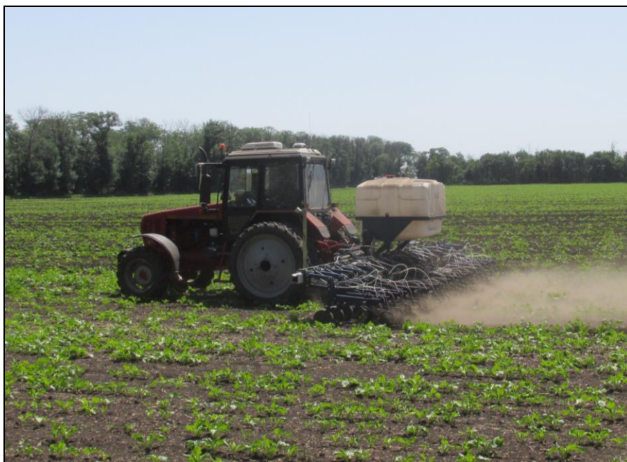
Рисунок 2 – Культиватор для междурядной обработки почвы товарного знака «AGROKRAFT», модель ГЕЛИОС-8,1 (18×45) в агрегате с трактором Беларус 1221.3, на междурядной обработке свеклы полольными лапами
