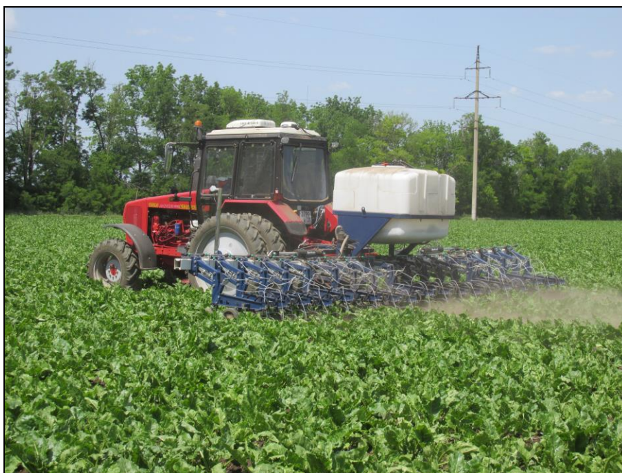
Рисунок 3 – Культиватор для междурядной обработки почвы товарного знака «AGROKRAFT», модель ГЕЛИОС-8,1 (18×45) в агрегате с трактором Беларус 1221.3, на междурядной обработке свеклы рыхлительными лапами
