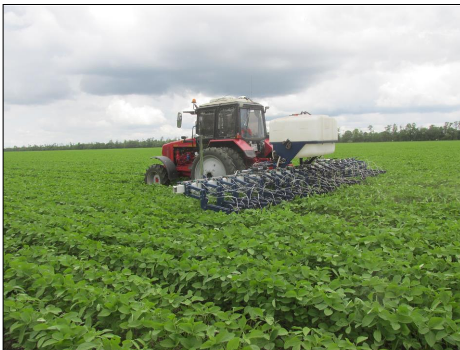
Рисунок 3 – Культиватор для междурядной обработки почвы товарного знака «AGROKRAFT», модель ГЕЛИОС-8,1 (18×45) в агрегате с трактором Беларус 1221.3, на междурядной обработке сои рыхлительными лапами
