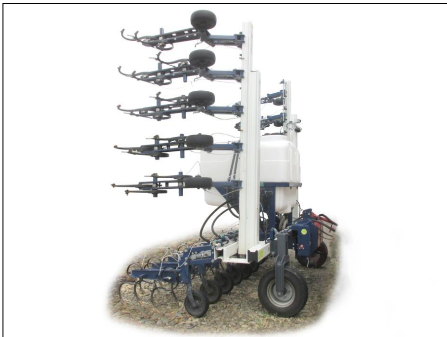
Рисунок 1 – Культиватор для междурядной обработки почвы товарного знака «AGROKRAFT», модель ГЕЛИОС-8,1 (18×45), в транспортном положении, вид спереди справа
