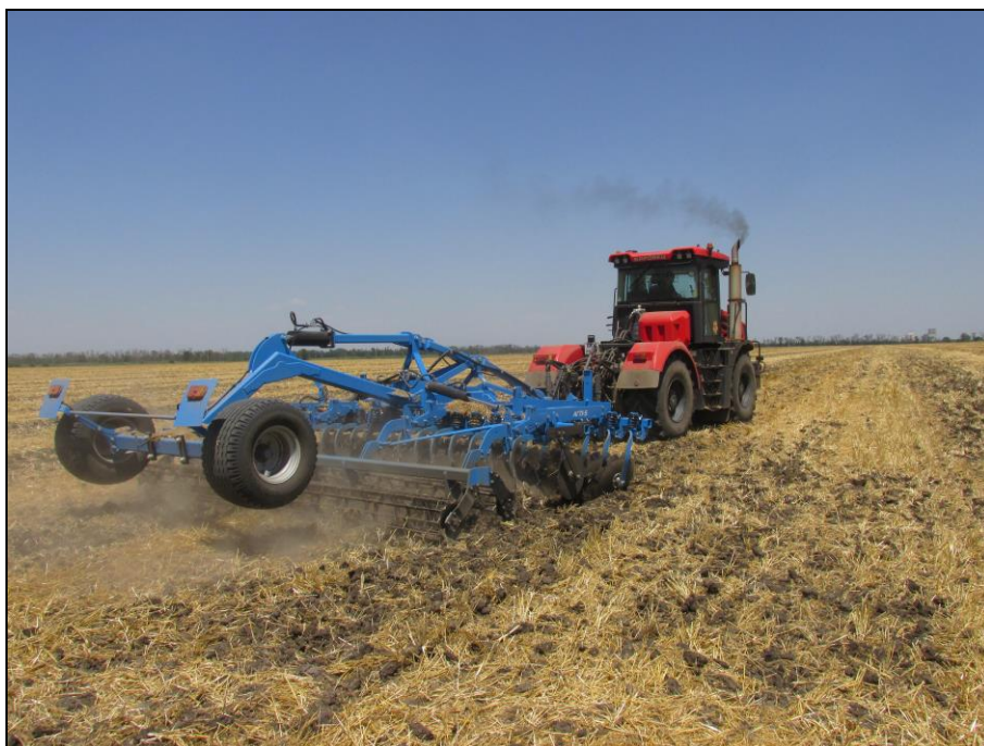
Рисунок 2 – Борона дисковая полунавесная модель АГЛ-5 в агрегате с трактором Кировец К-525Пр на дисковом лущении стерни озимой пшеницы (2 след)
