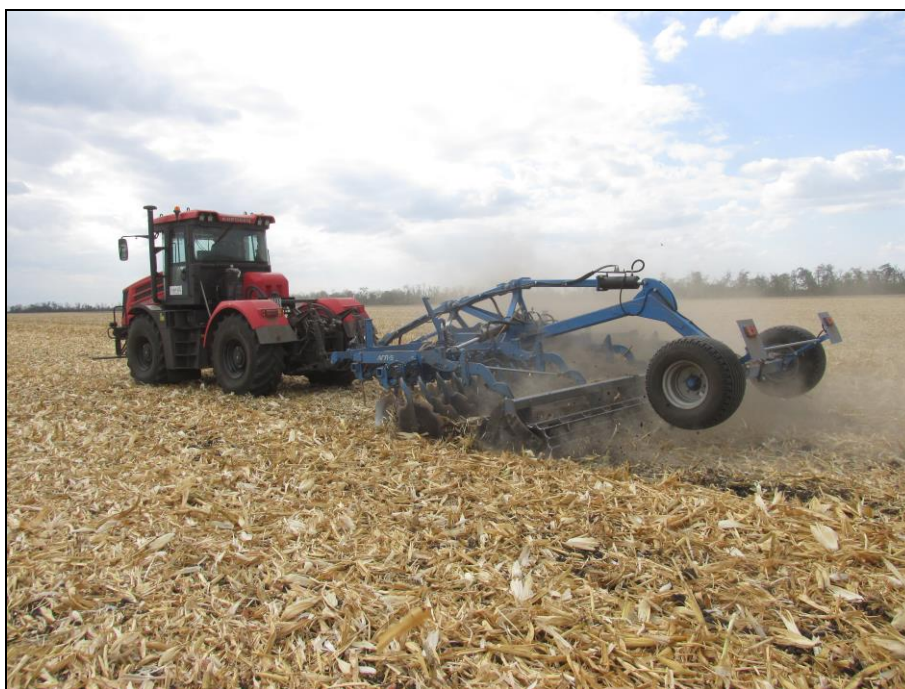
Рисунок 3 – Борона дисковая полунавесная модель АГЛ-5 в агрегате с трактором Кировец К-525Пр на дисковом лущении пожнивных остатков кукурузы (1 след)
