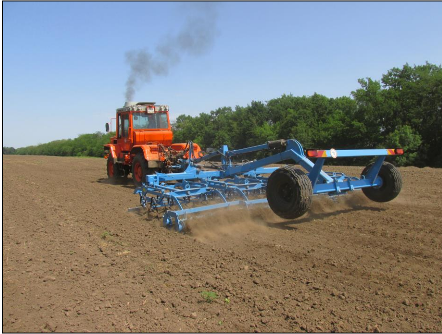
Рисунок 2 – Культиватор торговой марки "TIGARBO" модель КПП-6 в агрегате с трактором Т-151 на предпосевной обработке почвы
