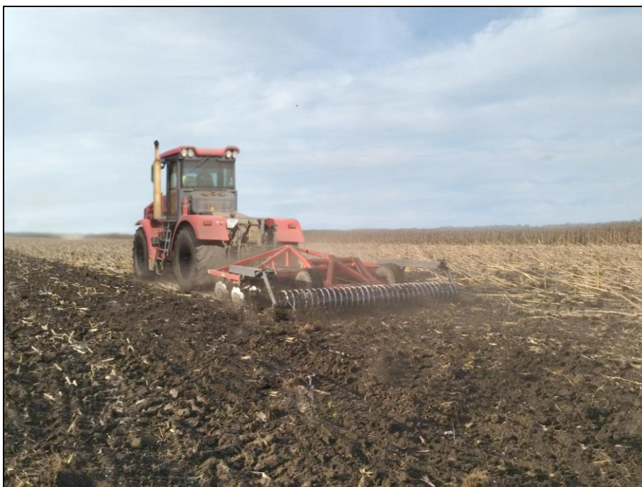
Рисунок 3 – Борона дисковая (Дискатор) БДМ-4×4ПР в агрегате с трактором Кировец К-744Р1 на дисковом лущении пожнивных остатков подсолнечника
