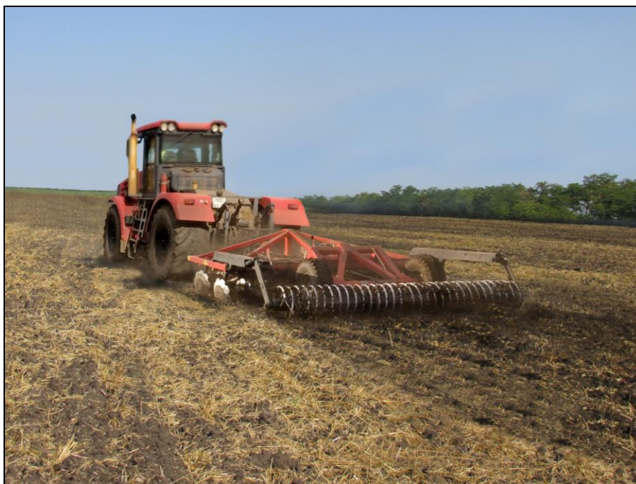
Рисунок 2 – Борона дисковая (Дискатор) БДМ-4×4ПР в агрегате с трактором Кировец К-744Р1 на дисковом лущении стерни озимой пшеницы
