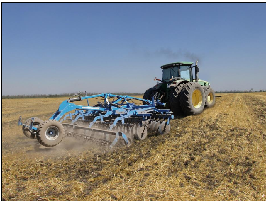
Рисунок 2 – Борона дисковая МUX-750, в агрегате с трактором John Deere 8310R на дисковом лущении стерни озимой пшеницы
