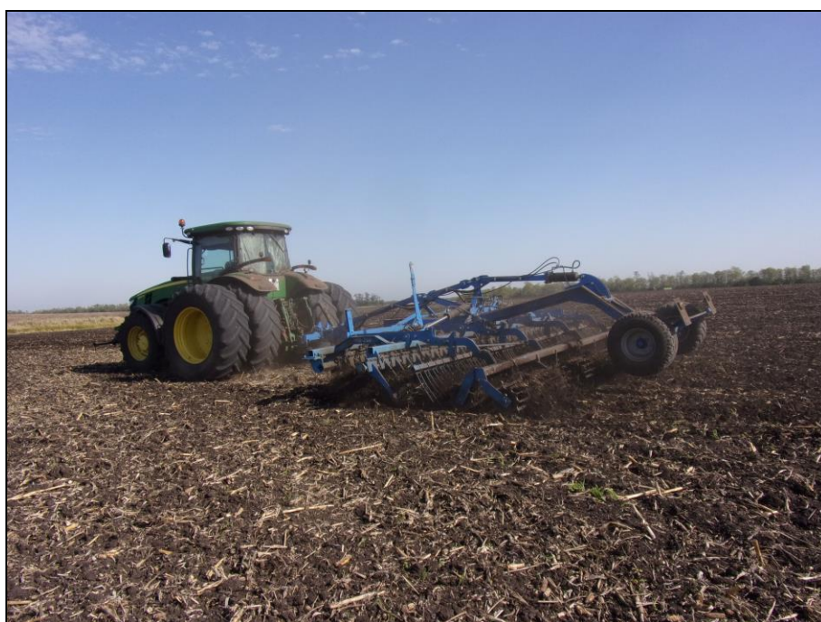
Рисунок 3 – Борона дисковая МUX-750, в агрегате с трактором John Deere 8310R на дисковом лущении пожнивных остатков кукурузы
