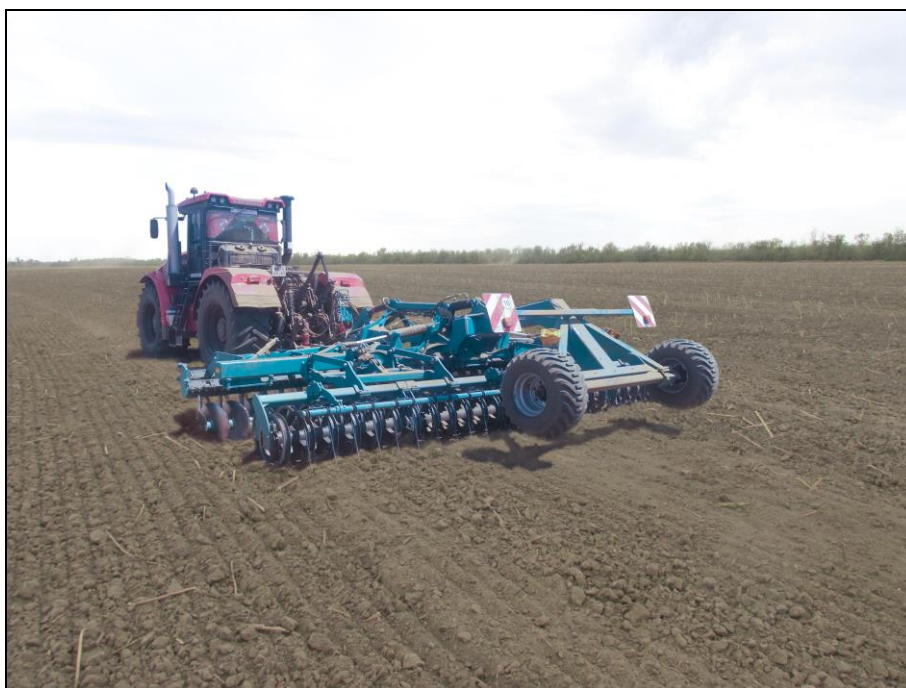
Рисунок 3 – Луцильник дисковый тяжелый полуприцепной складной М-7000ПС М "Мастер", в агрегате с трактором К-743 на дисковом луцении пожнивных остатков подсолнечника
