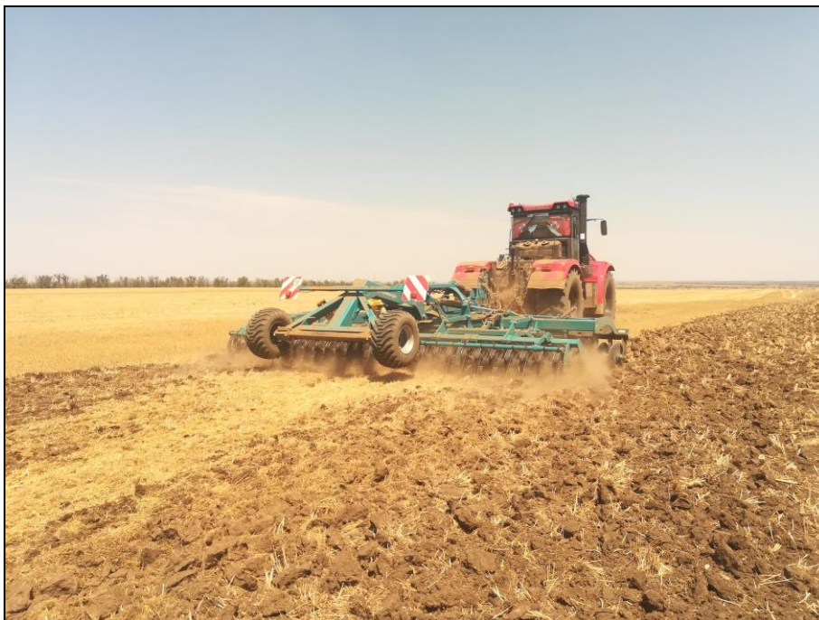
Рисунок 2 – Луцильник дисковый тяжелый полуприцепной складной М-7000ПС М "Мастер", в агрегате с трактором К-743 М на дисковом луцении стерни озимой пшеницы
