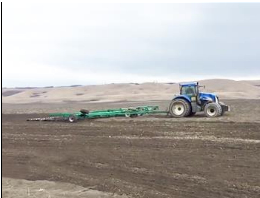
Рисунок 2 – Борона зубовая гибкая "ТРИУМФ" БЗГ-16, в агрегате с трактором New Holland T8.380 в работе, на поверхностном рыхлении почвы и удалении сорняков
