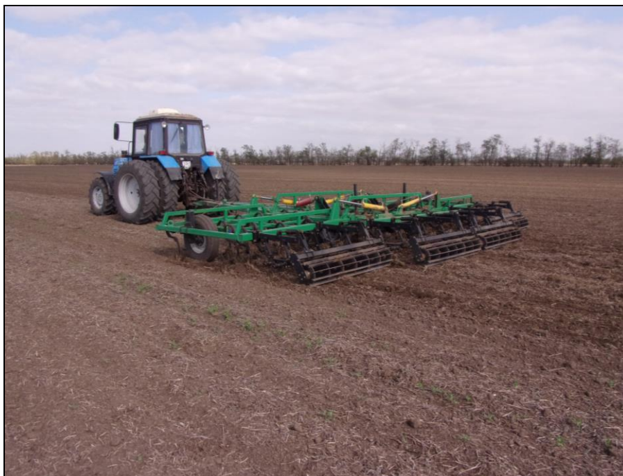
Рисунок 2 – Культиватор для сплошной обработки почвы КСОГ-8 в агрегате с трактором Беларус 1221.2 на предпосевной обработке почвы
