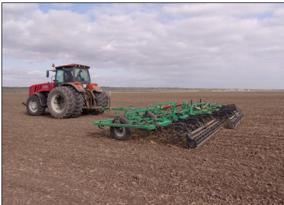
Рисунок 2 – Культиватор для сплошной обработки почвы КСОГ-10 в агрегате с трактором Беларусь 3022 ДЦ.1 на предпосевной обработке почвы
