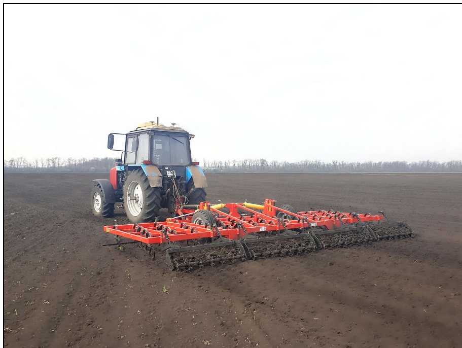
Рисунок 2 – Культиватор КСО-6МТ в агрегате с трактором Беларус-1221.2, на предпосевной обработке почвы
