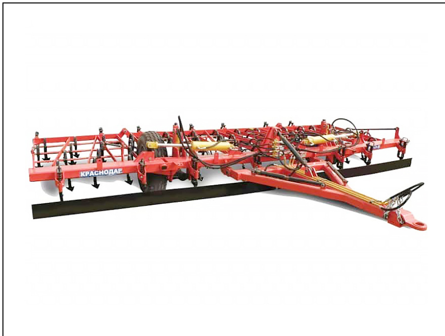
Рисунок 1 – Культиватор КСО-6МТ, вид спереди справа
