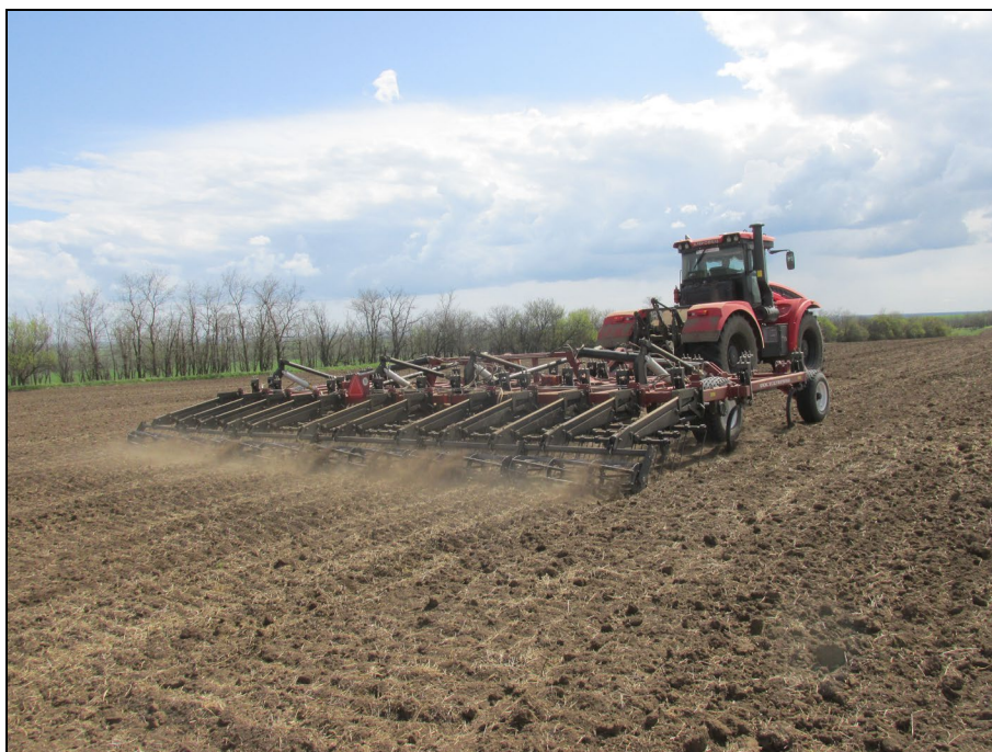
Рисунок 3 – Культиватор для сплошной обработки почвы К-10200 в агрегате с трактором К-739 ст1 на сплошной обработке почвы
