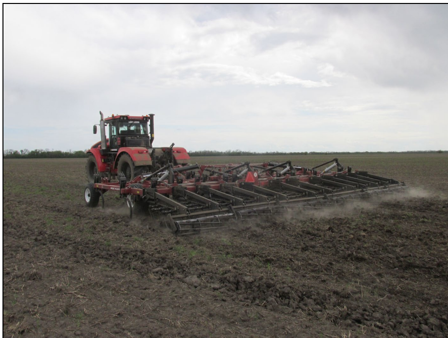
Рисунок 2 – Культиватор для сплошной обработки почвы К-10200 в агрегате с трактором К-739 ст1 на предпосевной обработке почвы
