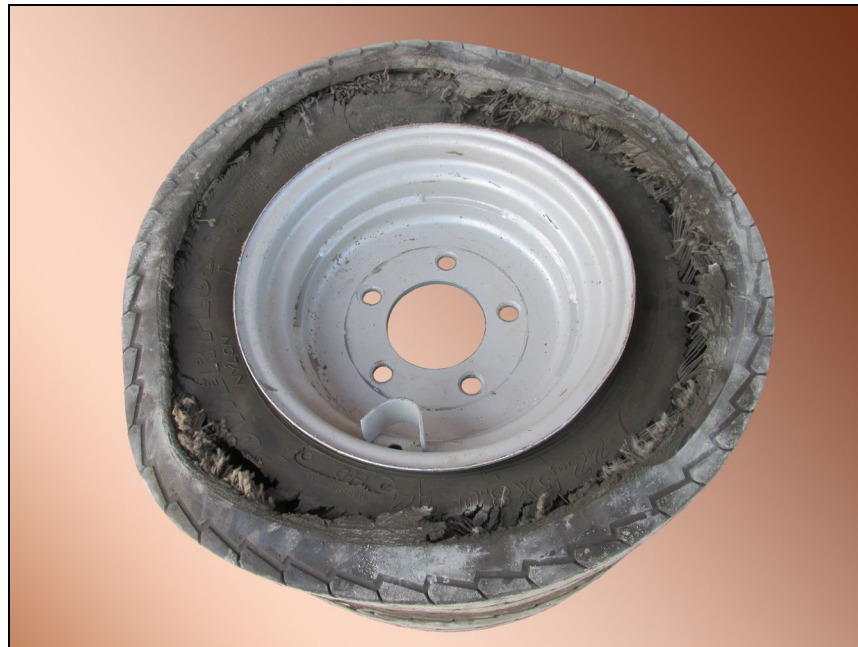
Рисунок А1 – Разрыв покрышки опорного колеса
