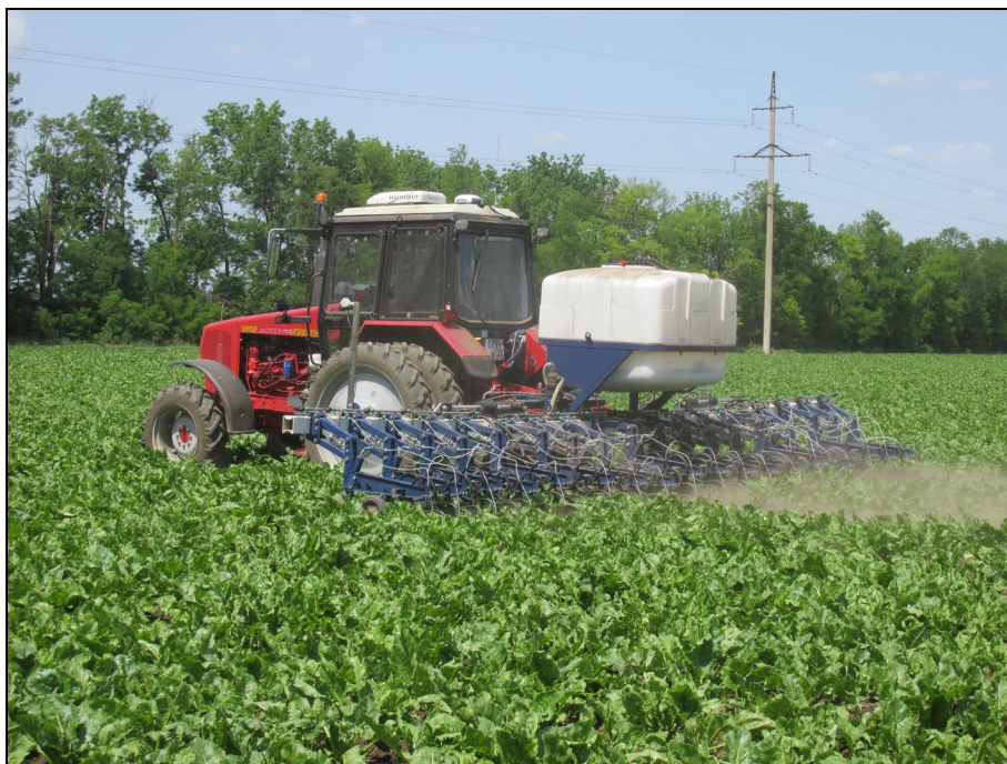
Рисунок 3 – Культиватор для междурядной обработки почвы товарного знака «AGROKRAFT», модель ГЕЛИОС-8,1 (18×45) в агрегате с трактором Беларус 1221.3, на междурядной обработке свеклы рыхлительными лапами
