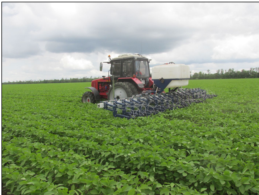
Рисунок 3 – Культиватор для междурядной обработки почвы товарного знака «AGROKRAFT», модель ГЕЛИОС-8,1 (18×45) в агрегате с трактором Беларус 1221.3, на междурядной обработке сои рыхлительными лапами
