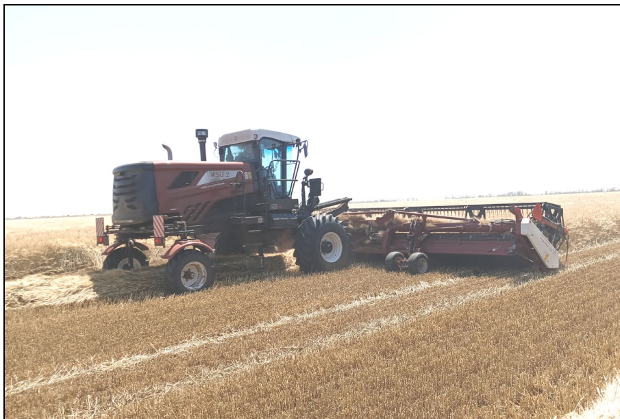
Рисунок 2 – Косилка валковая транспортерная КБТ-2 «Draper Flow 1250» в агрегате с косилкой самоходной универсальной КСУ-2 «RSM W 2260» на скашивании и укладке в валок озимой пшеницы
