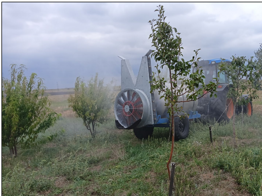
Рисунок 2 – Опрыскиватель для сельского хозяйства и садоводства модели ОПВ /Велес 2000, в работе на обработке садовых деревьев инсектицидом
