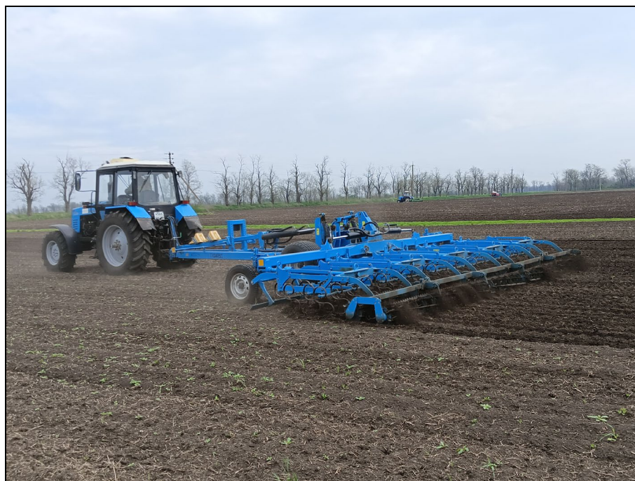
Рисунок 2 – Культиватор торговой марки "TIGARBO" модель КПП-7,5 в агрегате с трактором Беларус 1221.2 на предпосевной обработке почвы
