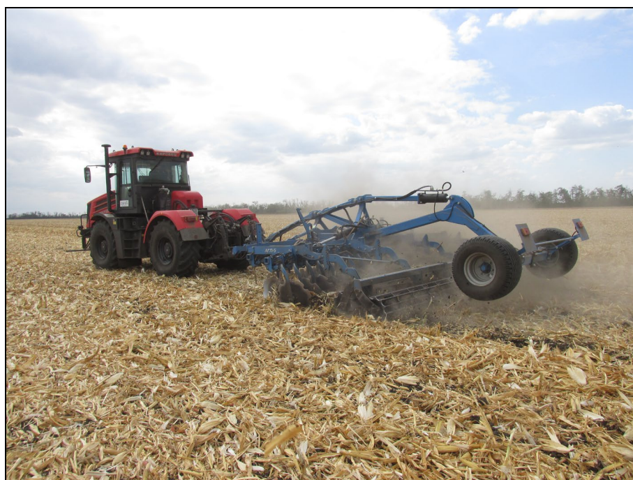
Рисунок 3 – Борона дисковая полунавесная модель АГЛ-5 в агрегате с трактором Кировец К-525Пр на дисковом лущении пожнивных остатков кукурузы (1 след)
