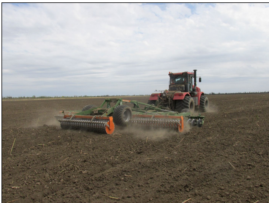
Рисунок 3 – Борона дисковая Catros+ 8003-2ТХ в агрегате с трактором К-744 Р4 на дисковом лушении пожнивных остатков подсолнечника (2 след)
