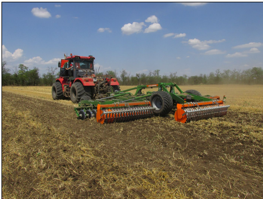
Рисунок 2 – Борона дисковая Catros+ 8003-2ТХ в агрегате с трактором К-744 Р4 на дисковом лушении стерни озимой пшеницы (1 след)
