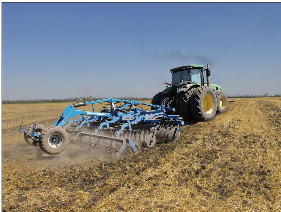
Рисунок 2 – Борона дисковая МUX-750, в агрегате с трактором John Deere 8310R на дисковом лушении стерни озимой пшеницы
