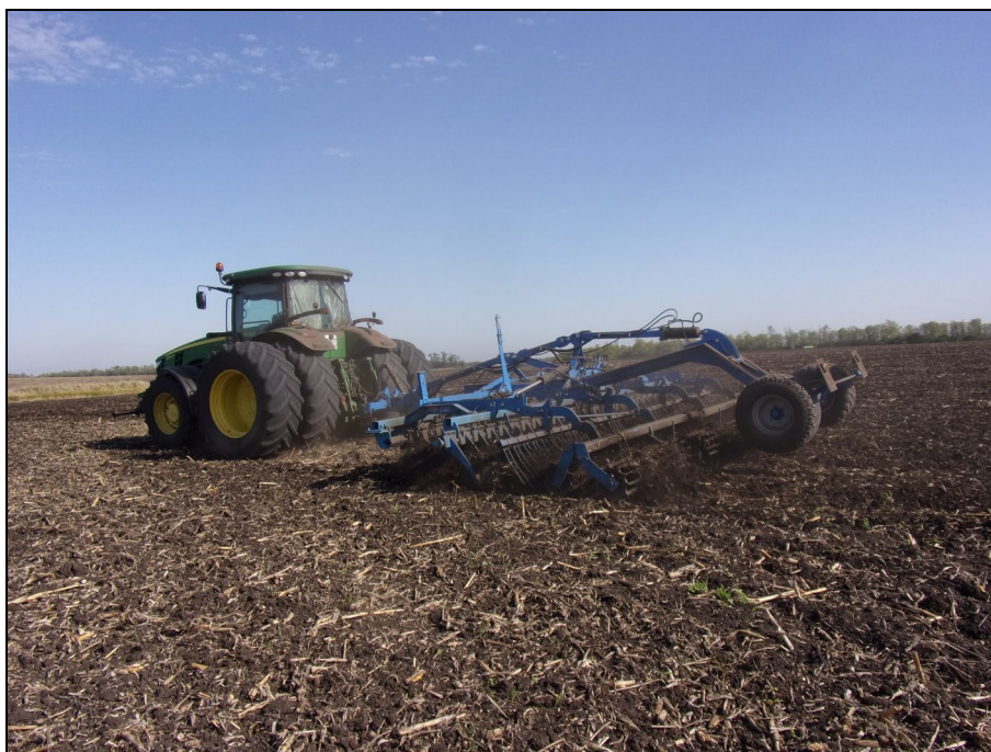
Рисунок 3 – Борона дисковая МUX-750, в агрегате с трактором John Deere 8310R на дисковом лушении пожнивных остатков кукурузы
