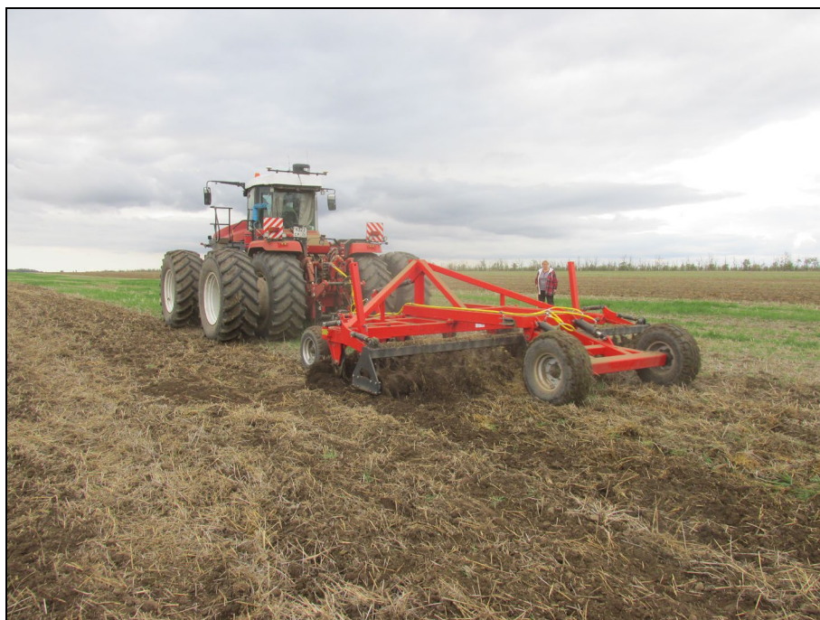
Рисунок 2 – Плуг чизельный ПЧ-4,5ПМ в агрегате с трактором Ростсельмаш RSM 2400 на безотвальной обработке почвы
