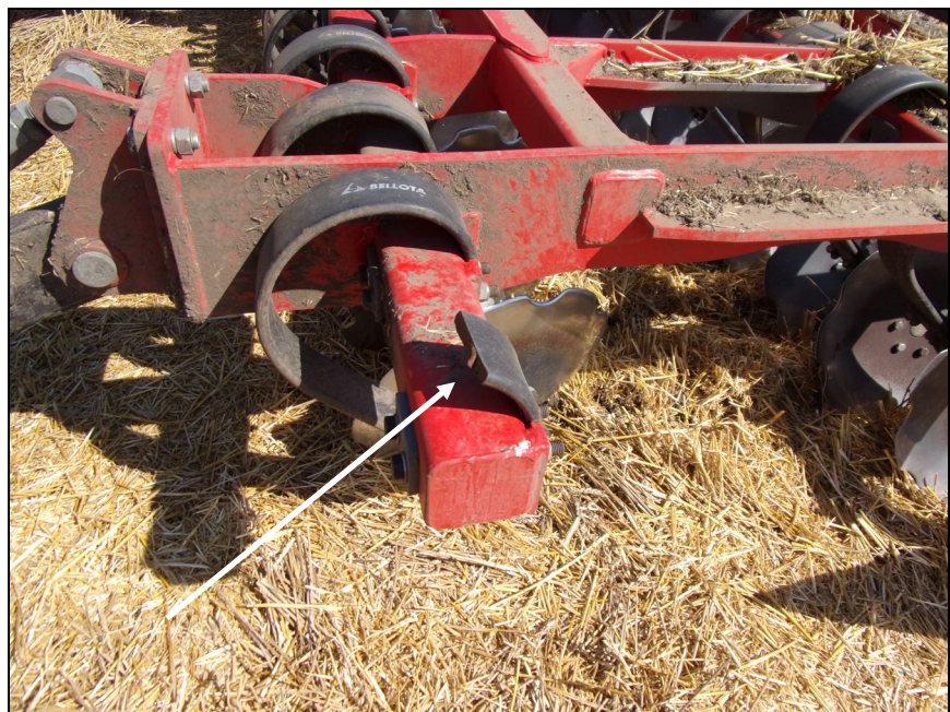
Рисунок А.1 – Излом индивидуальной пружинной стойки рабочего органа (сферического диска).
