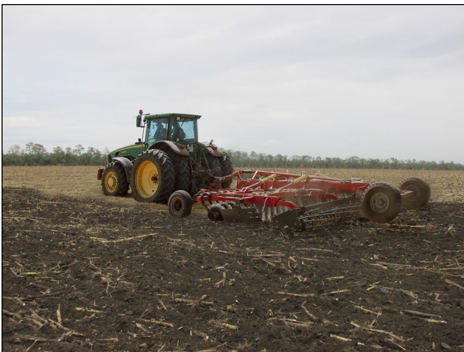
Рисунок 3 – Борона дисковая (Дискатор-мульчировщик) merus 6 в агрегате с трактором John Deere 8430 на дисковом лущении пожнивных остатков подсолнечника
