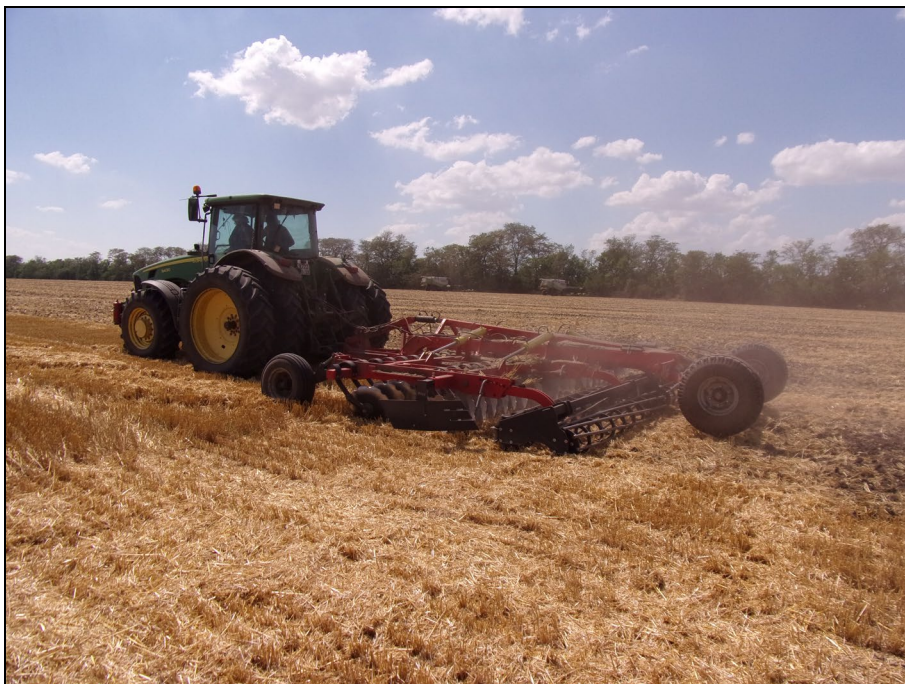
Рисунок 2 – Борона дисковая (Дискатор-мульчировщик) merus 6 в агрегате с трактором John Deere 8430 на дисковом лущении стерни озимой пшеницы
