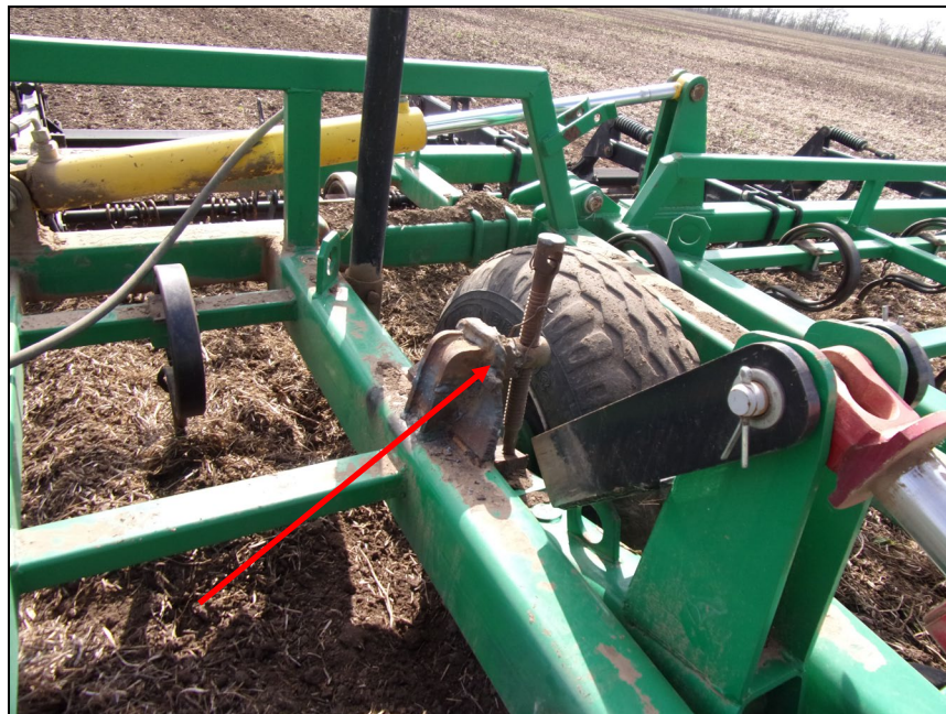
Рисунок А.1 - Излом кронштейна регулировочного винта каретки
