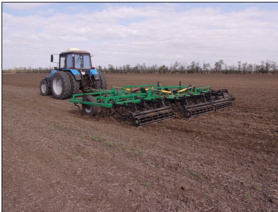
Рисунок 2 – Культиватор для сплошной обработки почвы КСОГ-8 в агрегате с трактором Беларусь 1221.2 на предпосевной обработке почвы
