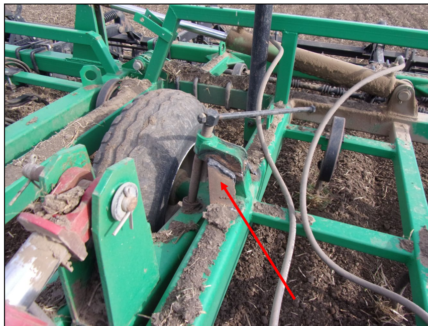
Рисунок А.1 - Излом кронштейна регулировочного винта каретки
