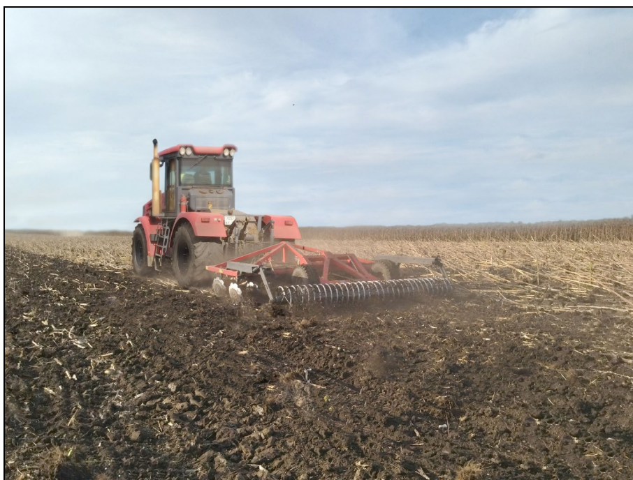
Рисунок 3 – Борона дисковая (Дискатор) БДМ-4×4ПР в агрегате с трактором Кировец К-744Р1 на дисковом лушении пожнивных остатков подсолнечника
