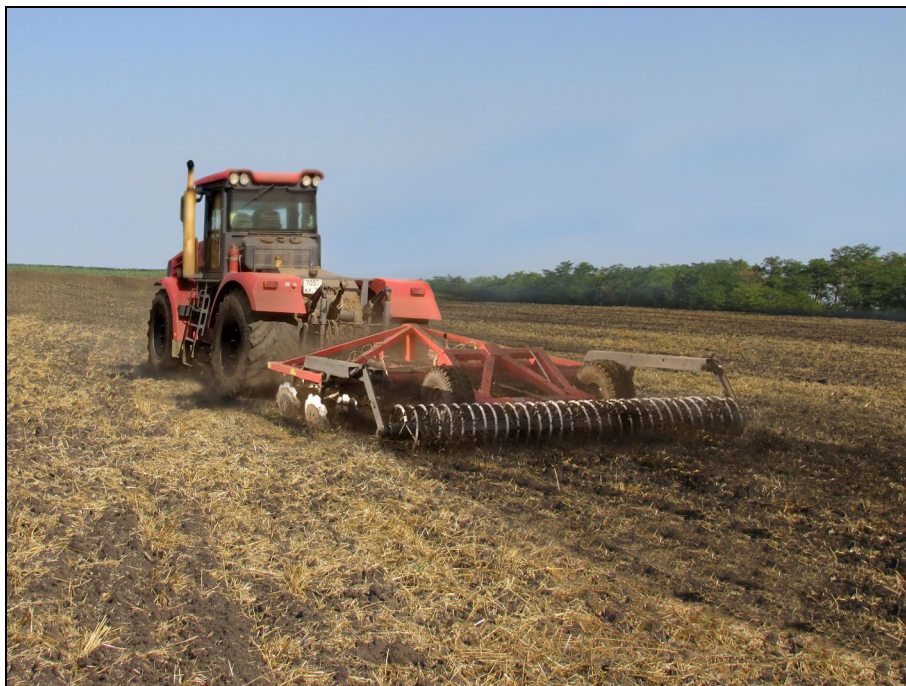
Рисунок 2 – Борона дисковая (Дискатор) БДМ-4×4ПР в агрегате с трактором Кировец К-744Р1 на дисковом лушении стерни озимой пшеницы
