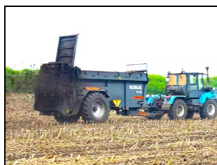
Разбрасыватель РОУМ-14 "Хозяин" на разбрасывании органических удобрений
