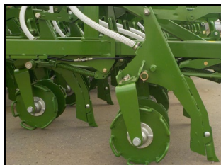
Сеялка Primera DMC 9000. Рабочие органы – долотообразные сошники и двойные опорные диски
