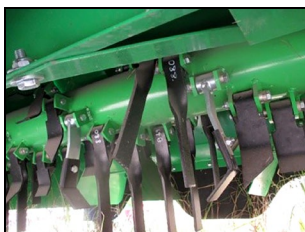
Ботводробитель AVR Rafale 4×75. Рабочие органы – битеры (ножи)
