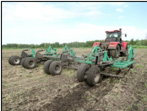
Культиватор "Кузбасс" К-8,5 в агрегате с трактором К-744Р3 на обработке паров
