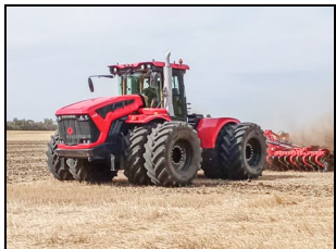
Трактор "Кировец" К-730М Стандарт 1 в агрегате с дисковой боронкой Gaspardo UFO на дисковании стерни
