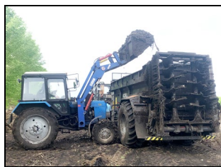
Вид на рабочие органы разбрасывателя РОУМ-14 "Хозяин" с вертикальной битерной системой при загрузке
