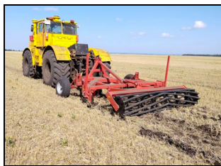
Плуг чизельный навесной ПЧН-3,0КТ в работе в агрегате с трактором К-700А
