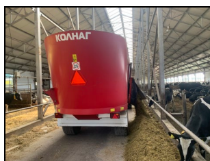
Смеситель-кормораздатчик TRIOLIET Solomix 2 1800 ZK на приготовлении кормосмеси
