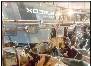
Смеситель-раздатчик кормов СРК-11В "ХОЗЯИН" на раздаче кормосмеси
