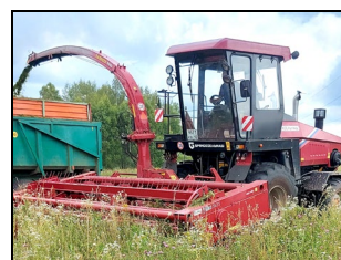
Комбайн К-Г-6 с жаткой для трав на кошении трав
