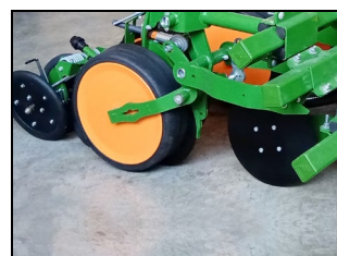
Сеялка EDX 12000-ТС. Рабочие органы - двухдисковые сошники, туковые сошники и уплотняющие катки
