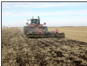
Чизельно-дисковый агрегат ЧДА-5.М в агрегате с трактором RSM-3435 на обработке почвы
