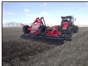
Трактор "Кировец" К-525 Пр в агрегате с машиной дисковой почвообработывающей ДМ-6П на лущение стерни зерновых культур
