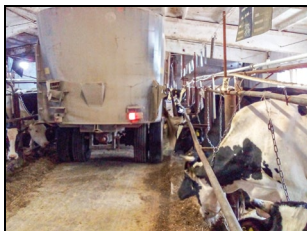
Смеситель раздатчик кормов СРК-16В "Хозяин", на раздаче кормосмеси
