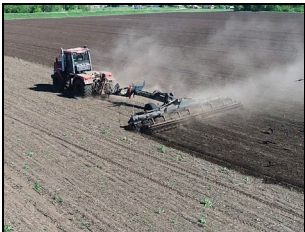
Борона дисковая прицепная "VELES" БДП-10.М в агрегате с трактором К-744Р4 на обработке почвы парового поля
