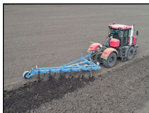
Трактор "Кировец" К-525 Пр в агрегате с ПНУ-6х35 Е на отвальной обработке почвы
