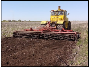
Борона дисковая навесная БДН 6×2 в агрегате с трактором К-701, на обработке стерни подсолнечника
