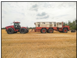
Трактор "Кировец" К-730М Стандарт 1 со двоянными колесами в агрегате с тяговой лабораторией ТЛК "Кировец" при проведении энергетической оценки
