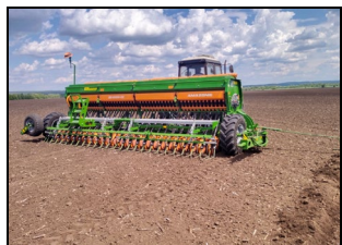
Сеялка D9 6000-ТС на посеве в агрегате с трактором MT3-1221
