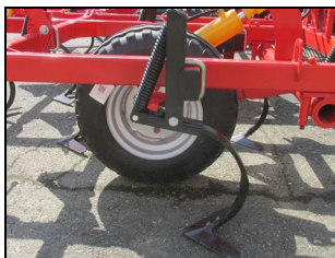
Рабочие органы – С-образная подпружиненная стойка со стрелчатой лапой
