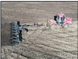
Борона дисковая прицепная "VELES" БДП-10.М в агрегате с трактором К-744Р4 на лущении стерни крупностебельных культур
