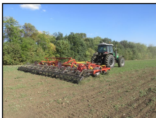
Культиватор КСКП-8 в агрегате с трактором UMG T2204, на паровой обработке почвы
