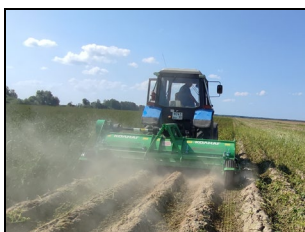
Ботводробитель AVR Rafale 4×75 в агрегате с трактором Беларус 82.1 на измельчении ботвы
