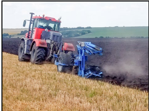
Плуг оборотный ППО-6 (5+1) на основной обработке почвы в агрегате с трактором К-524
