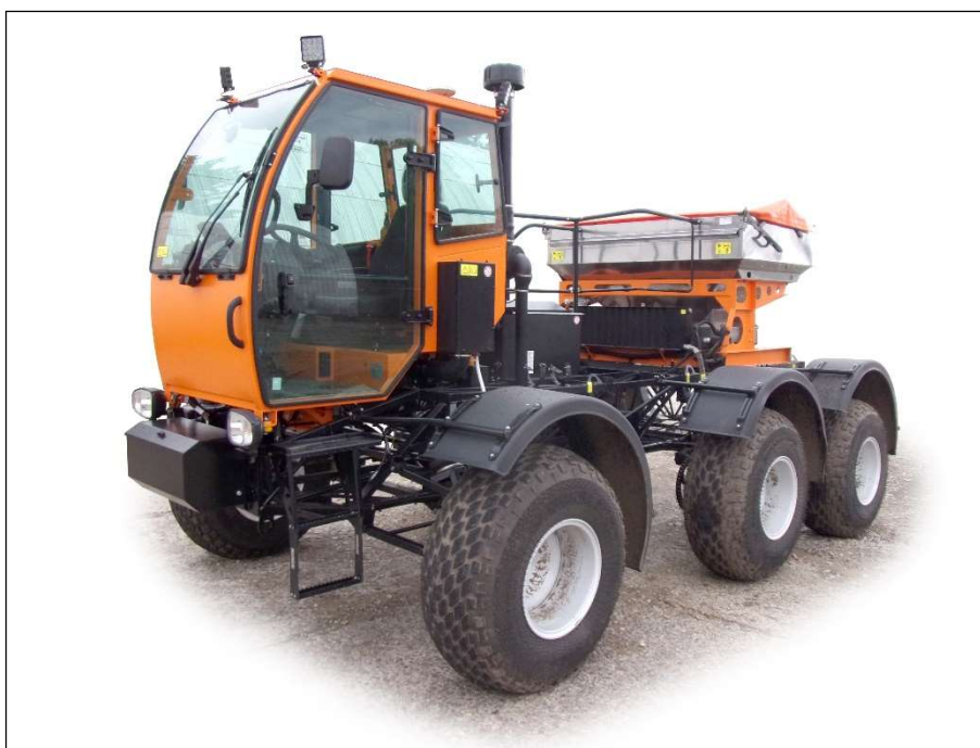
Рисунок 1 – Опрыскиватель-разбрасыватель самоходный ТУМАН-1М комплектуемый сменным технологическим оборудованием (разбрасывателем ТУМАН-1), на рабочих шинах низкого давления, вид спереди слева
