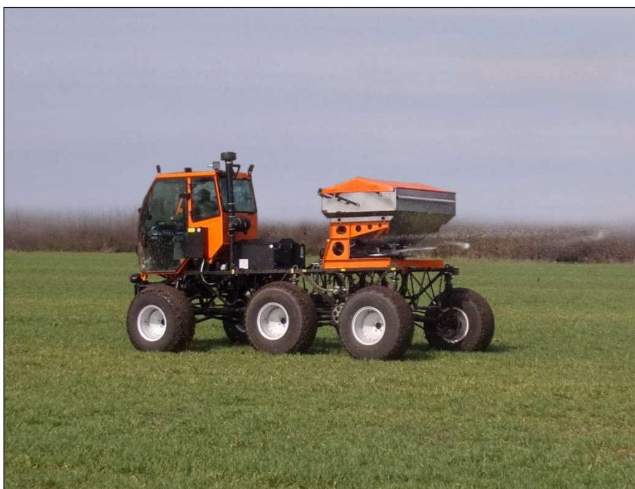
Рисунок 2 – Опрыскиватель-разбрасыватель самоходный ТУМАН-1М комплектуемый сменным технологическим оборудованием (разбрасывателем ТУМАН-1), на внесении аммиачной селитры по озимой пшенице
