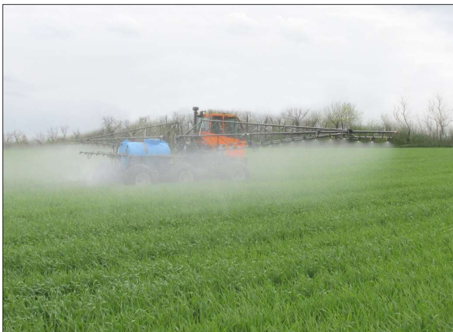
Рисунки 2, 3 – Опрыскиватель-разбрасыватель самоходный ТУМАН-1М, комплектуемый сменным технологическим оборудованием (штанговым опрыскивателем ТУМАН-1), на опрыскивании озимой пшеницы пестицидами
