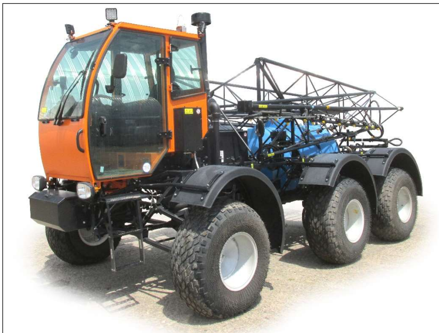
Рисунок 1 – Опрыскиватель-разбрасыватель самоходный ТУМАН-1М комплектуемый сменным технологическим оборудованием (штанговым опрыскивателем ТУМАН-1), на шинах низкого давления, вид спереди слева
