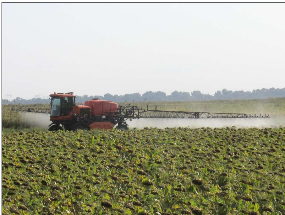
Рисунки 2-3 – Опрыскиватель-распределитель самоходный ТУМАН-4 комплектуемый сменным технологическим оборудованием (штанговым опрыскивателем ТУМАН-4), на опрыскивании десикантами подсолнечника
