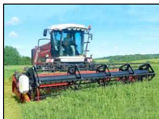
Косилка валковая транспортерная КВТ 7-14 "Draper Flow 700" в агрегате с КСУ-1 на скашивании трав
