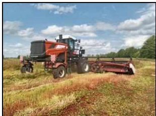
Косилка валковая транспортерная КВТ-2 "Draper Flow 1050" в агрегате с самоходным энергосредством КСУ-2 "RSM W 2260" на скашивании гречихи
