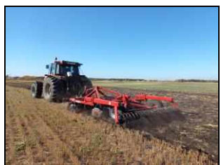
Борона дисковая модульная прицепная БДМП-3×4 в агрегате с трактором CASE INTERNATIONAL 7110 в работе на стерновом фоне зерновых культур
