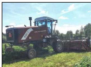
Косилка валковая транспортерная КВТ 7-14 "Draper Flow 700" в агрегате с КСУ-1 на скашивании трав и укладке срезанной массы в центральный валок
