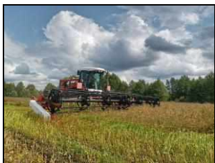
Косилка валковая транспортерная КВТ-2 "Draper Flow 1050" на скашивании гречихи
