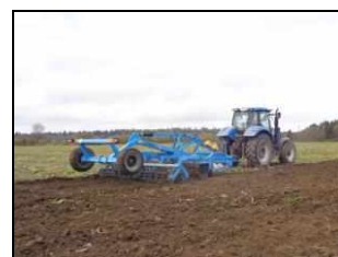
Агрегат дисковый полунавесной, товарный знак "TIGARBO", модель АД-4 в агрегате с трактором NEW HOLLAND T6090 на обработке почвы с пожнивными остатками крупнотельных культур
