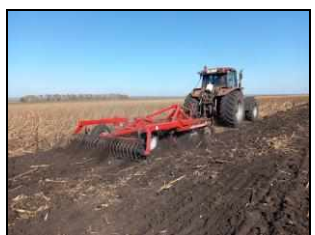
Борона дисковая модульная прицепная БДМП-3×4 в агрегате с трактором CASE INTERNATIONAL 7110 в работе на стерновом фоне крупнотельных культур (подсолнечника)
