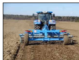
Агрегат дисковый полунавесной, товарный знак "TIGARBO", модель АД-4 в агрегате с трактором NEW HOLLAND T6090 на подготовке почвы для посева
