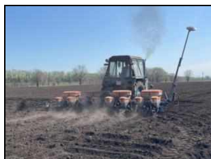
Сеялка пропашная "МС-8" в агрегате с трактором МТЗ-82.1 на посеве семян подсолнечника
