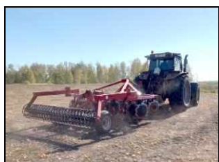
Борона дисковая модульная прицепная БДМП-3×4 в агрегате с трактором CASE INTERNATIONAL 7110 в транспортном положении
