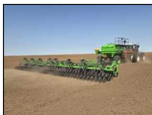
Посевной комплекс Дон 578 в агрегате с трактором RSM- 2400 на посеве семян озимой пшеницы
