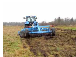
Агрегат дисковый полунавесной, товарный знак "TIGARBO", модель АД-4 в агрегате с трактором NEW HOLLAND T6090 на обработке залежных земель
