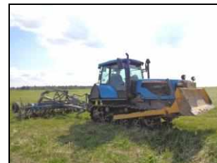
Трактор гусеничный сельскохозяйственный АГРОМАШ 110ТГ 2047М с боронами дисковыми Рубин 9/400 КА на разделке дернины многолетних трав
