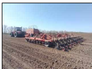
Посевной комплекс FEATAGRO APU-9800 в агрегате с трактором "Кировец" К-739М на посеве семян яровой пшеницы
