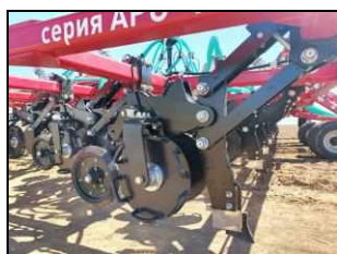
Анкерный сошник с двумя регулируемыми опорными колесами и прикатывающим колесом
