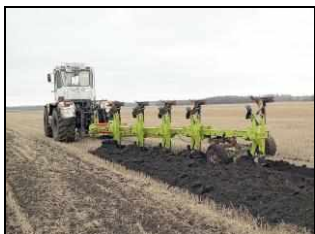
Плуг оборотный модульный ПОМ-4/7 в агрегате с трактором К-702М-СХТ на зяблевой вспашке
