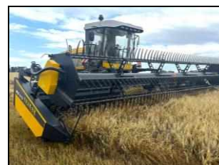
Косилка самоходная КС-150 "Чулпан", с жаткой валковой ЖВ-910 на скашивании пшеницы в валок
