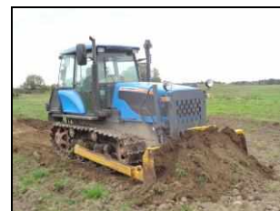
Трактор гусеничный сельскохозяйственный АГРОМАШ 110ТГ 2047М с сменным бульдозерным оборудованием ДЗ-42Р на планировке полей
