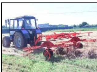
Грабли-ворошилка роторные ГВР-6Р в агрегате с трактором Беларусь МТЗ 82.1 на срезании проявленной травы в валок
