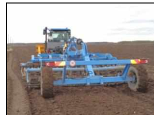
Трактор гусеничный сельскохозяйственный АГРОМАШ 110ТГ 2047М с агрегатом дисковым "TIGARBO", АД-4 на подготовке почвы для посева
