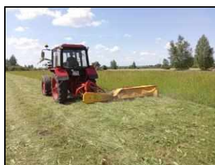
Косилка роторная навесная КРН-2,4 на скашивании естественных трав
