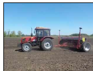
Сеялка СЗ-5,4В в агрегате с трактором БЕЛАРУС-952,3 на посеве озимой пшеницы
